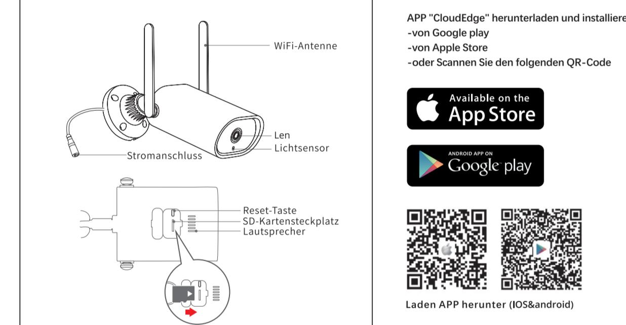
**ACHTUNG:** Bitte legen Sie die Micro SD-Karte gemäß der im Diagramm gezeigten Richtungen ein. Die Micro SD-Karte kann sich verkleben, wenn sie falsch eingesetzt wird und das Gerät beschädigt.
